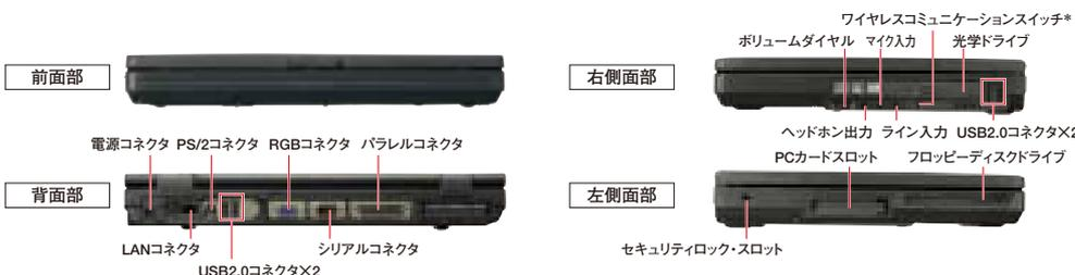
\*電波を発してはいけない場所などで使用の際に、無線通信機能の電波の発信を停止するスイッチです。
